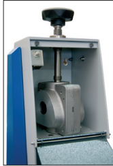
Detalle de la cámara portamufas.
